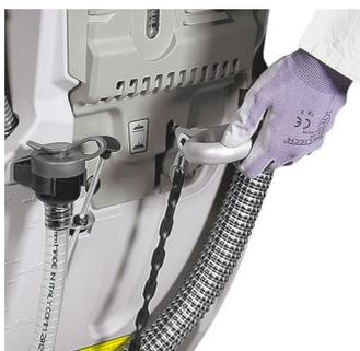
La chaîne d'abaissement du suceur est robuste, elle est réalisée en acier et munie d'une poignée ergonomique en aluminium moulé sous pression
