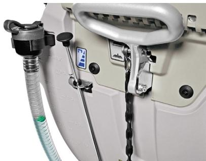
Le niveau du réservoir est toujours sous contrôle grâce à un indicateur prévu à cet effet. Cette solution est très utile aussi bien dans la phase de remplissage que pendant le travail pour savoir à l'avance quand il faut s'arrêter.
