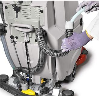
Pour assurer un séchage toujours impeccable du sol, il est essentiel de nettoyer le tuyau d'aspiration et les bavettes du suceur à la fin de chaque cycle de travail. Le suceur peut être soulevé pour pouvoir accéder aisément aux bavettes et les nettoyer rapidement
