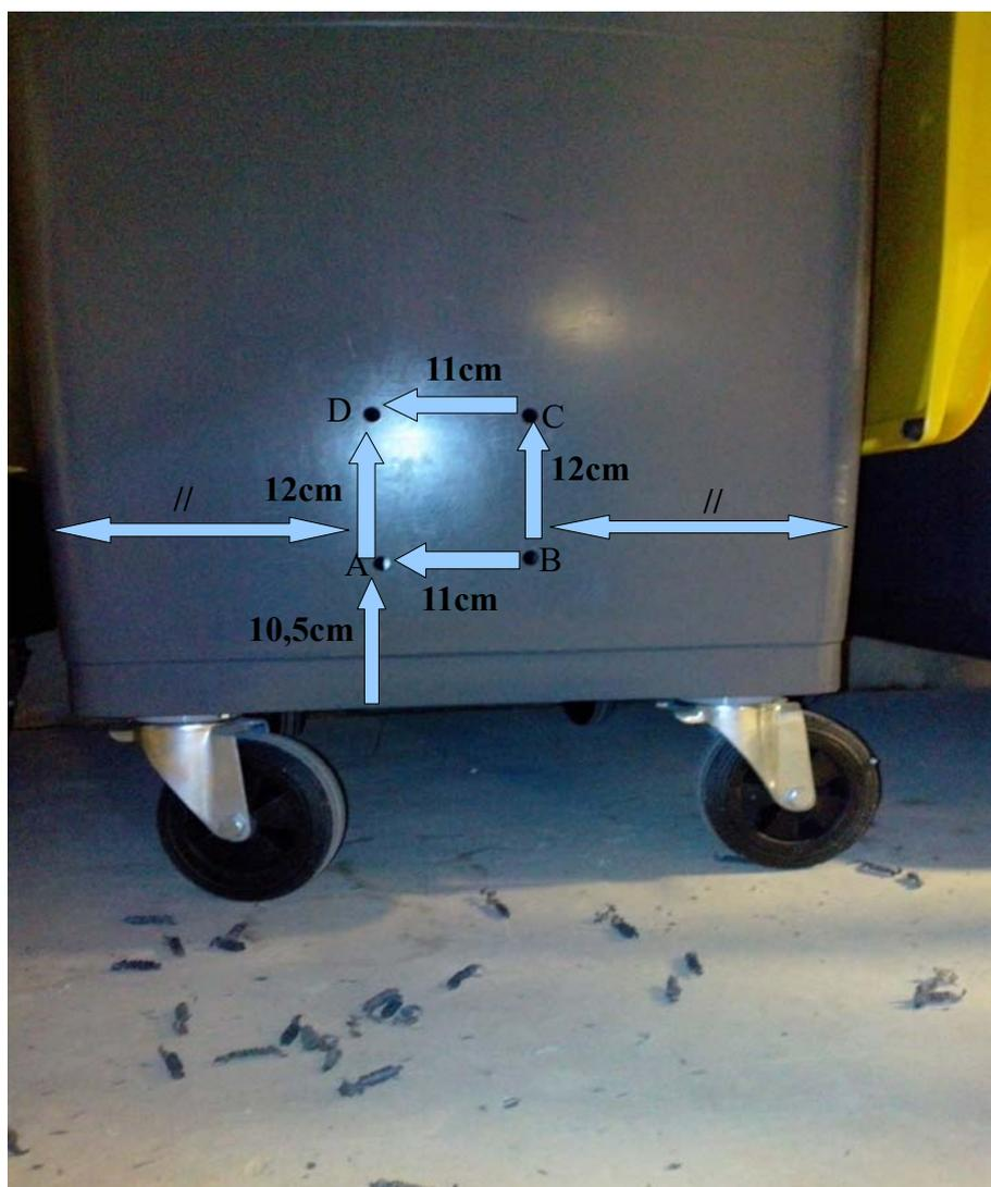
Une fois les 4 trous A,B,C,D percés, faites glisser une contre plaque à l'intérieur de la poubelle et faites passer les pattes de fixation par les trous.
