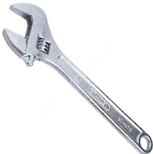
Clés à molette forgées. Mâchoires entièrement trempées et revenues, polies et chromées. Type américain. Conformes aux normes ISO 6787 et DIN 3711.
